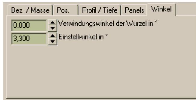
Wobei jede einzelne Knickstelle noch mal in sich selbst verwunden sein kann („Verwindungswinkel der Wurzel“ bzw. Reiter „Verwindung“ rechts für die Segmentknickstellen). Somit kann man also eine Verwindung der Tragfläche, d.h. einen veränderlichen Anstellwinkel verwirklichen.
