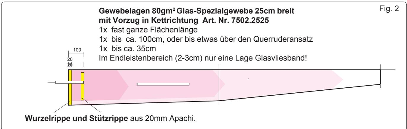
Beispiel eines Gewebe-Legeplanes für ein Segler mit 428cm Spannweite.
