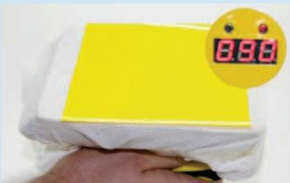
Abb. 3A Temperaturtest bei ca. 90°C
