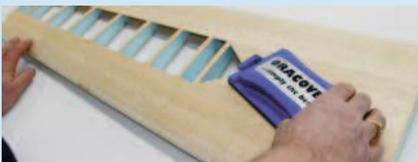
Abb. 2 Abschleifen der Oberfläche
