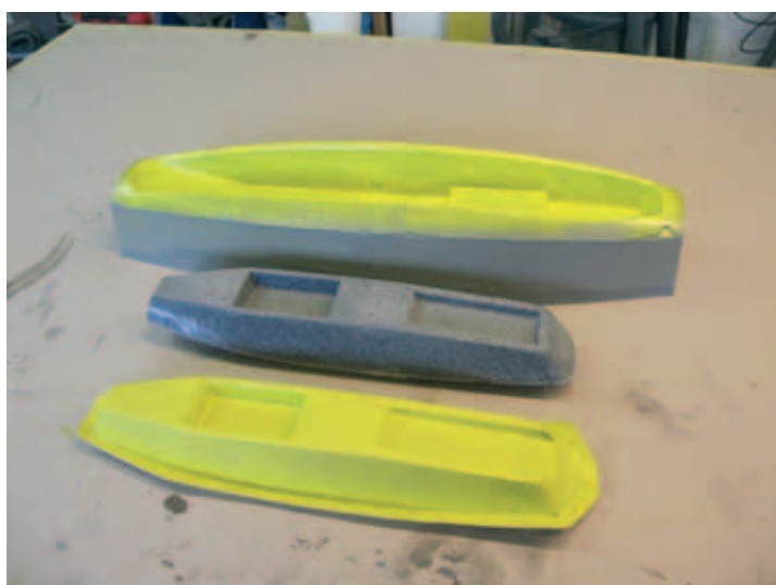
Urmodell und weiche Form aus PU-Giessharz für das Laminieren der Servo-Box.
