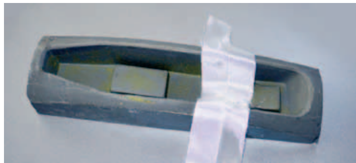
Form aus flexiblem PU für die Herstellung der Servo-Box
