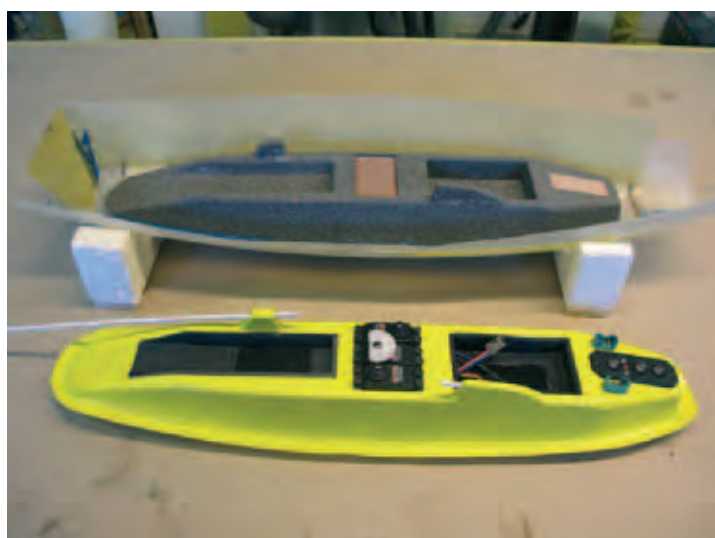
Urmodell und weiche Form aus PU-Giessharz für das Laminieren der Servo-Box.
