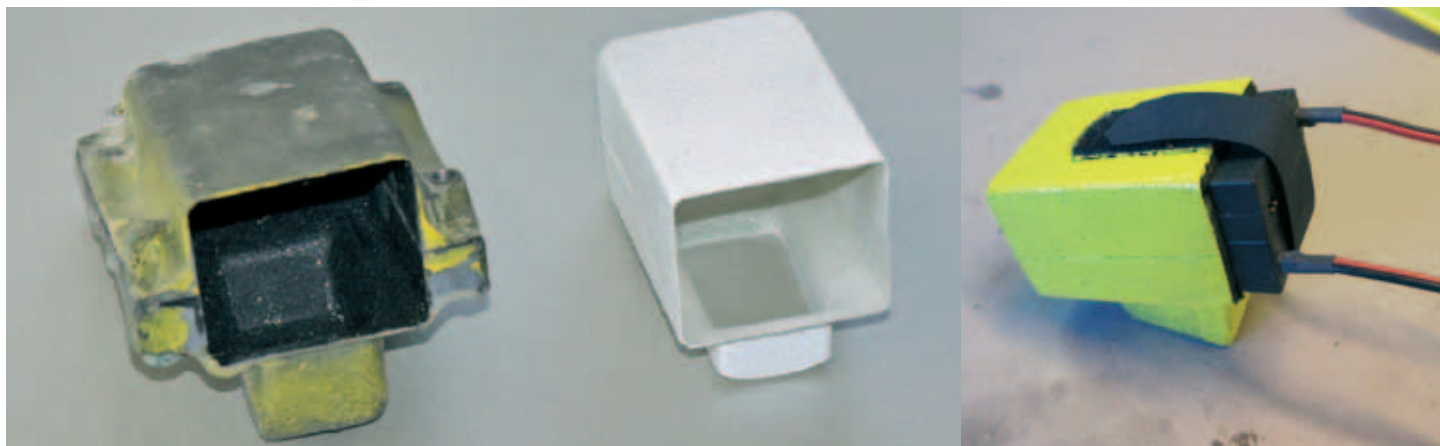
Form und fertige Box zum Einschieben der PowerBox Akkus in die Rumpfspitze.
