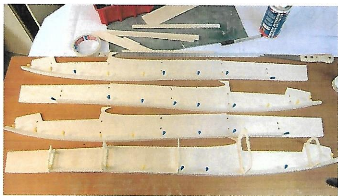
Los geht's mit dem Bau des Rumpfs. Auf dem Bild sind die Seitenteile mit aufgeklebten Dreikantleisten und aufgesteckten Spanten zu sehen.
