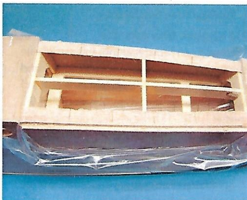
Das Gerüst der Kabinenhaube: Der vordere Dübel ist eingeklebt, hinten benutze ich zwei Magnete zu Fixierung.
