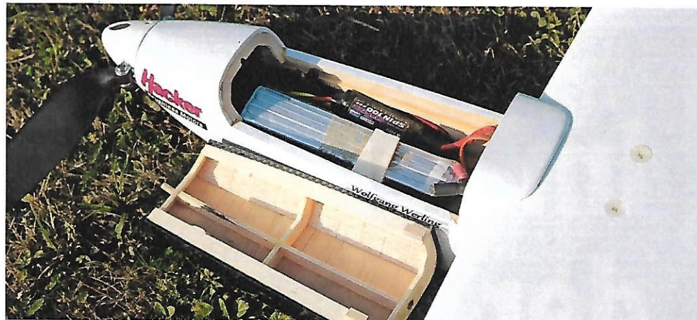
Meine eigene Motorisierungsvariante beim Hai 4 ist der Hacker A40-14 LV2 mit einem 5s-3.300-mAh-LiPo und 18,5x12-Propeller.
