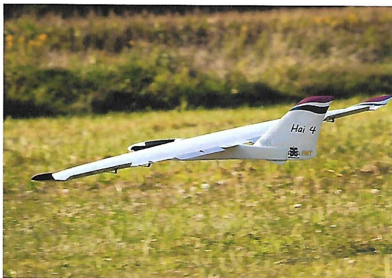
Meine eigene Motorisierungsvariante beim Hai 4 ist der Hacker A40-14 LV2 mit einem 5s-3.300-mAh-LiPo und 18,5x12-Propeller.
