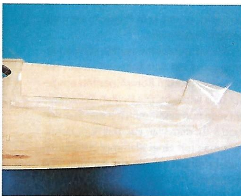
Die Kabinenhaube wird direkt auf dem Rumpf aufgebaut, eine Folie verhindert die unbeabsichtigte Verklebung.
