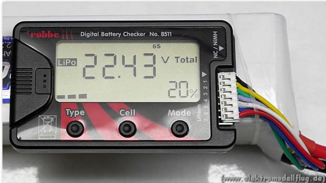
Stellvertretend für die LiPo-Checker hier ein Beispiel. Die Anzeige offenbart beim 6s-LiPo 22,43 V (3,73 V/Z). Zelle "6" blinkt und signalisiert Unterspannung (lässt sich alles per Menüführung einzeln abrufen). Der Füllgrad mit 20 % ist hier korrekt, was aber nicht immer der Fall sein muss!
