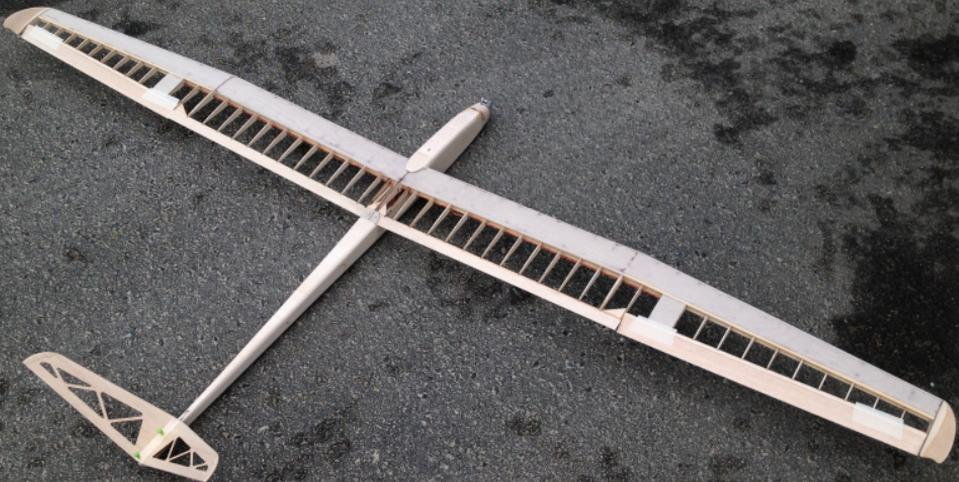
Der **Rock\_it** wurde für den Hangflug entwickelt und ist sehr universell einsetzbar. Durch das 1,5 Prozent gewölbte und nur 9 Prozent dicke Tragflächenprofil ergeben sich hervorragende Allroundeigenschaften.
